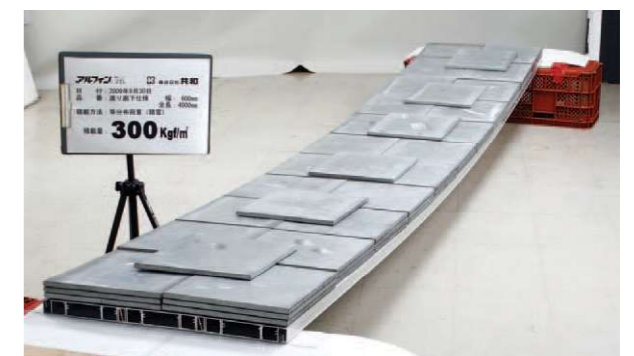
ADパネル 全長4000mmの風圧300kgf/m 2 本体パネルにフラットバーを内蔵しています。
